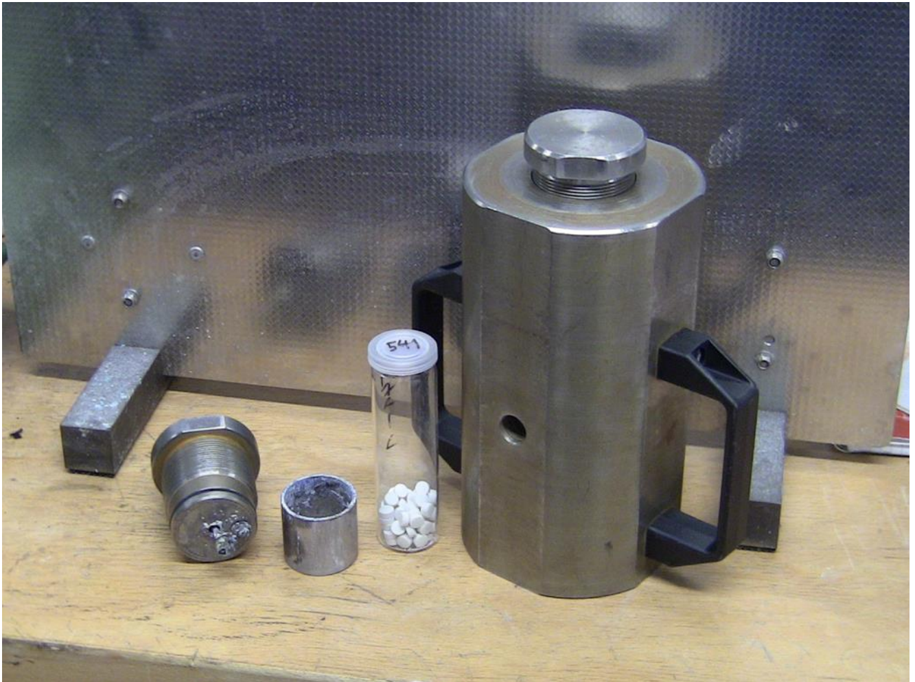
Abbildung 5: Ballistische Bombe zur Brennratenbestimmung; hier Schraubversion
