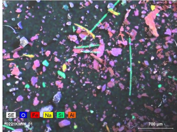
Bild 2: Übersichtsmapping blau: O, rot: Fe, gelb: Na, grün: Si, orange: Al
