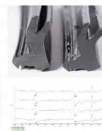
IR-Spektrum eines Dichtungswerkstoffes
