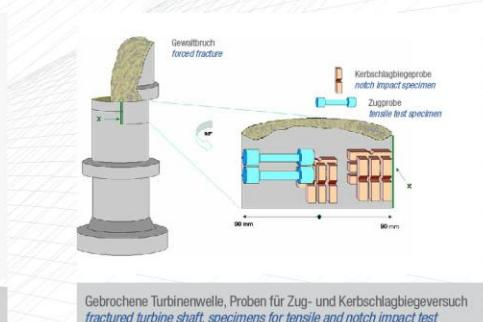
Gebrochene Turbinenwelle, Proben für Zug- und Kerbschlagbiegeversuch
