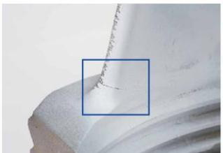
› Riss an einer Turbinenschaufel
