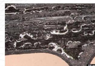
› Isolierung nicht vollständig ausgehärtet
