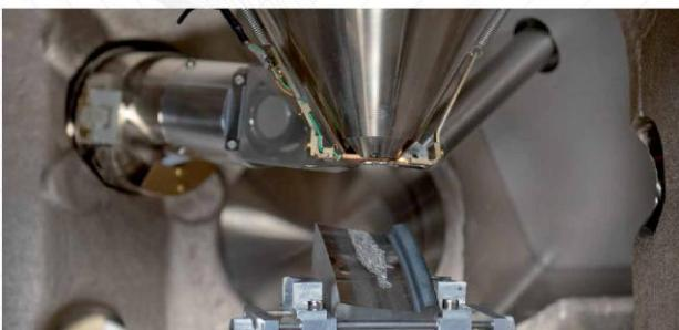
Probenkammer des Rasterelektronenmikroskops
