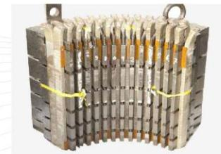
› Segment aus der Statorwicklung eines Elektromotors
