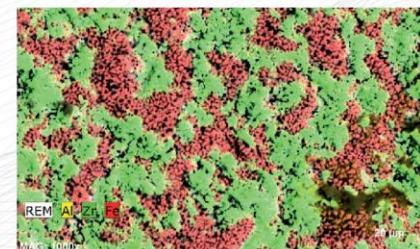
EDX-Mapping eisenhaltiger Beläge einer  $ZrO_2$ -Wärmedämmungsschicht
