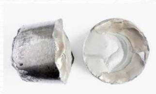
Geöffneter Riss in einem Wälzkörper
