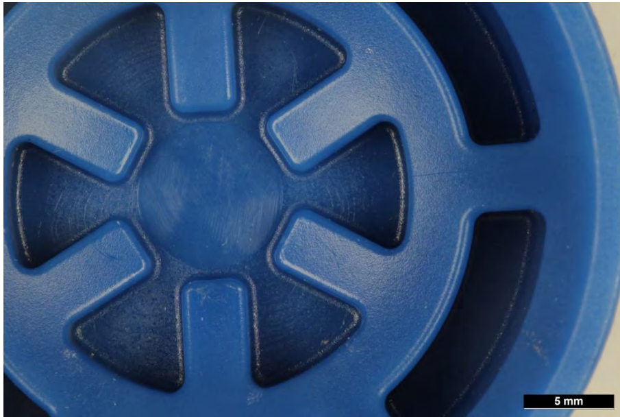
Bild 3 Detail Distanzrolle blau mit Schliere an Rippe unten
