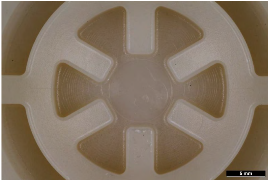
Bild 4 Detail Distanzrolle naturfarben mit Schliere an Rippe unten
